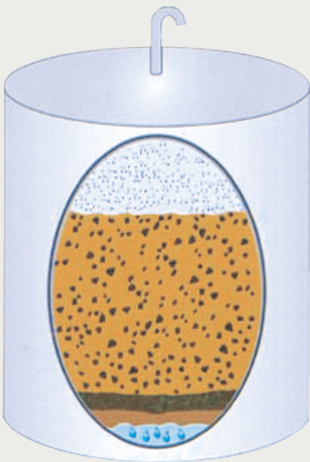
被灰尘，水分，滋生微生物等污染的典型储油罐。
