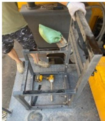
(拆卸过程中需堵住进气管，避免进灰)
