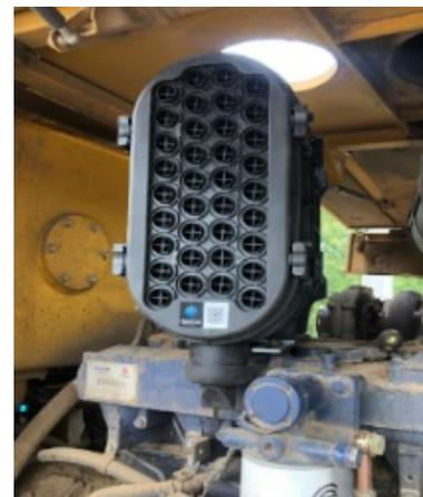
安装减震垫片，固定PXD11空滤器
