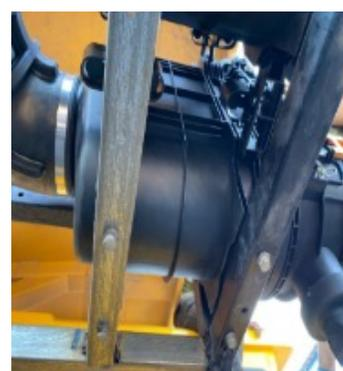
在相应孔位钻孔，用M8\*60 外六角螺栓固定DualPXD11
