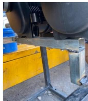
在原车支架中间加焊钢管作为支撑
