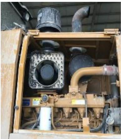
拆卸原有空滤总成和预滤器
