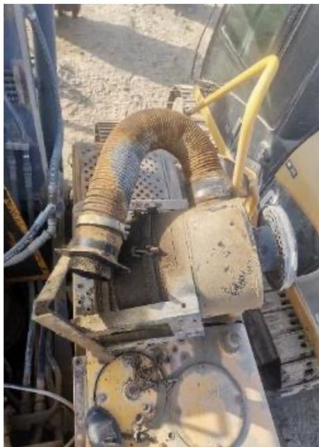
拆除原车空滤总成和加装的油浴式过滤器
