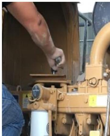
拆卸原车底板
