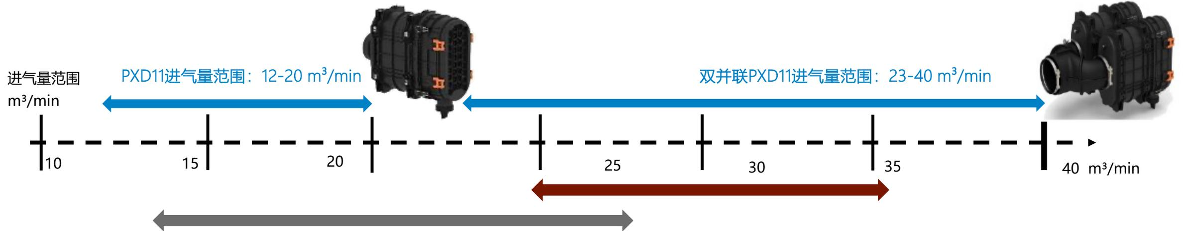
5T-7T (吨) 装载机进气量范围: 14.6-18  $m^3/min$
