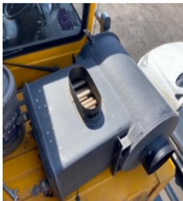
拆掉原有空滤总成，保留原有支架
