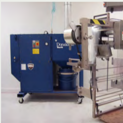
DFO除尘器通过与包装机进料斗和其振动管道的连接来捕获包装工序中产生的粉尘。
