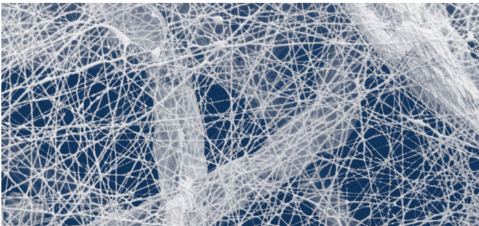
精细纤维滤材 (600倍放大) ——精细纤维表面过滤技术可用于所有 Ultra-Web® 和 Fibra-Web® 滤筒。
