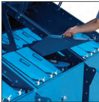
② 拧开固定螺母并取出过滤元件固定器/脉冲清灰导流器
