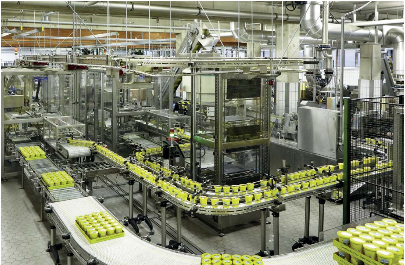
Abb. 2: Abfüllanlage für den Goldsaft Zuckerrübensirup in der Grafschafter Krautfabrik, Meckenheim
