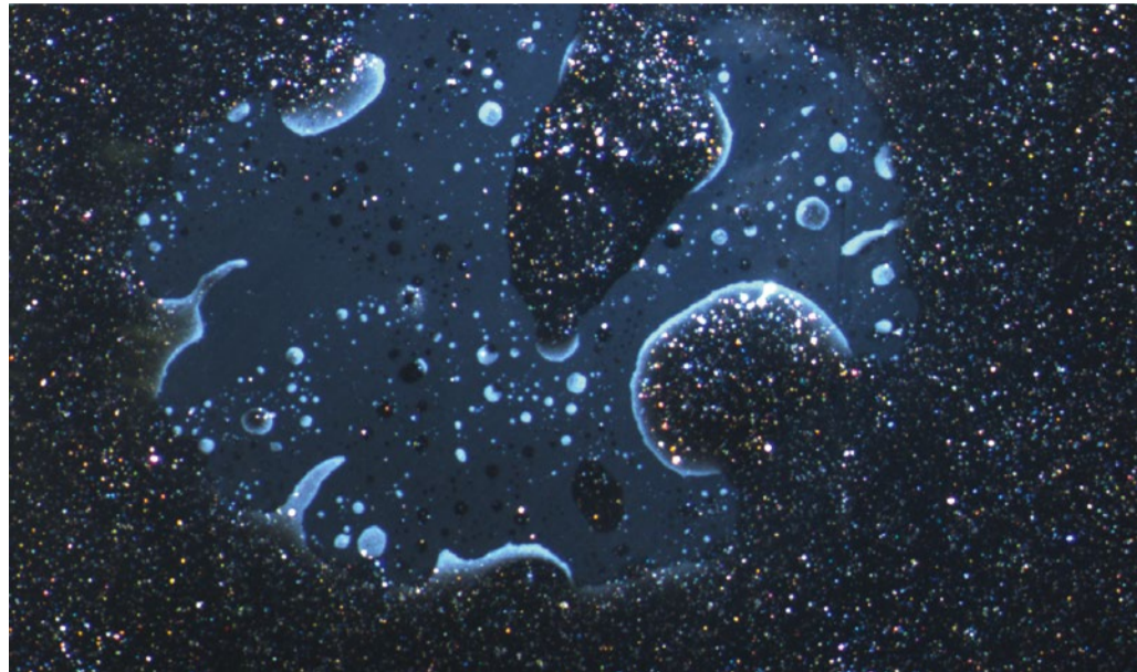
Siloxane können in Trennmitteln, Hautcremes und Weichspülern enthalten sein und verursachen häufig Lackierfehler; hier ein Lichtmikroskopiebild einer Benetzungsstörung. Foto: DFO
